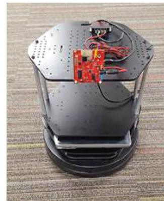
图 9. 安装在 Turtlebot 2 上的 IWR1443 EVM。
